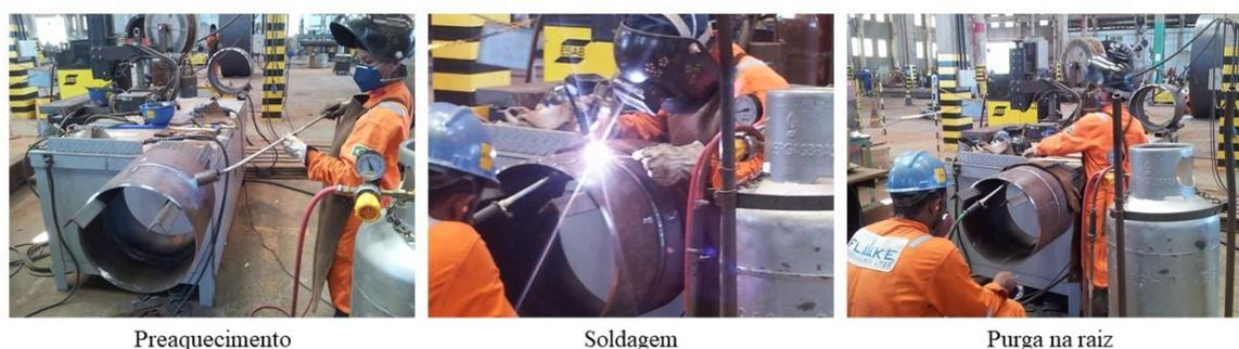
Figura 5: Algumas fases do processo de soldagem.
