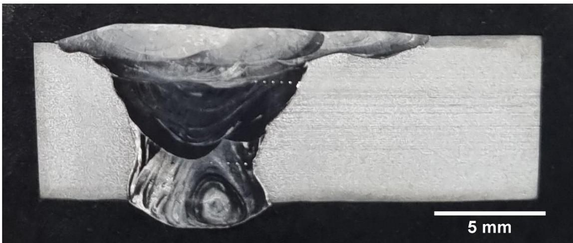
Figura 12: Macrografia da junta soldada. Aumento: 2X. Ataque: Nital 2% para o metal base e ácido oxálico a 10% para o metal de solda.
