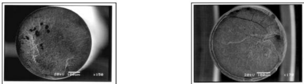
Figura 12: Análise de amostras de peças com falha por fadiga [3]
