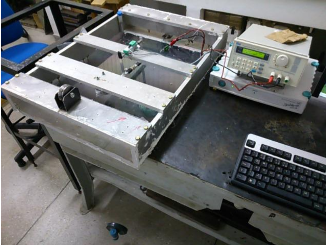
Figura 26 (b) : Dispositivo para análise de fadiga após modificações
