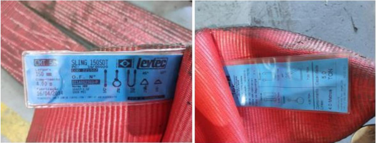
**Figura 37 - Presença das etiquetas nas cintas utilizadas**
