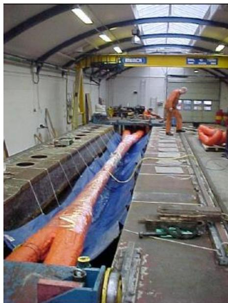
Figura 24 - Máquina de ensaio de tração para cintas poliméricas [68]
