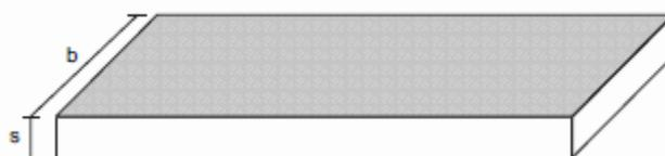
**Figura 22 - Largura (b) e espessura (s) da cinta [54]**
