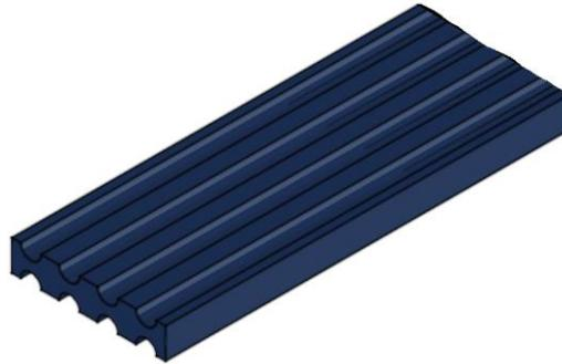
Figura 42: Geometria dos corpos de prova que tiveram injeção de fibras.
