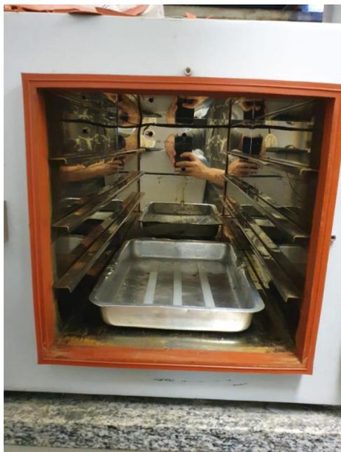
Figura 49: Inserção dos corpos de prova no interior da estufa.
