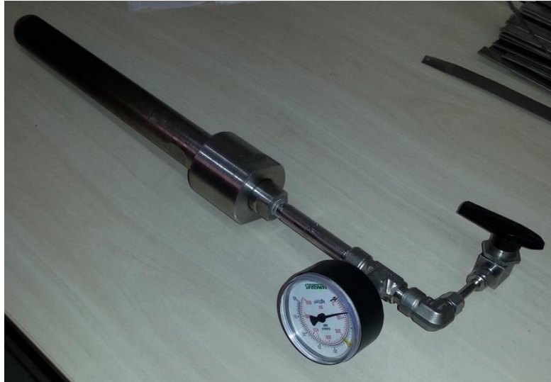
Figura 18 - Autoclave para realização da hidrogenação gasosa.
