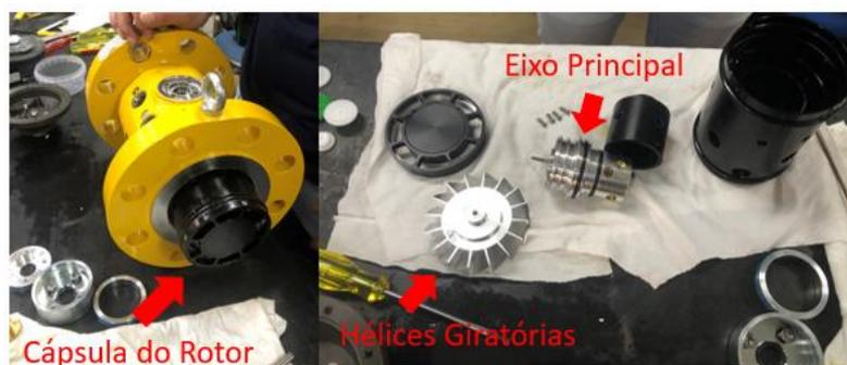
**Figura 24 - Peças Internas de um Medidor Turbina**
