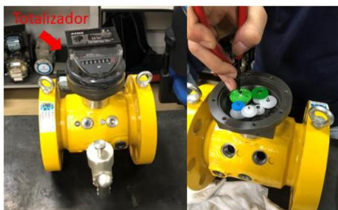
**Figura 25 - Sistema de Funcionamento do Totalizador**
